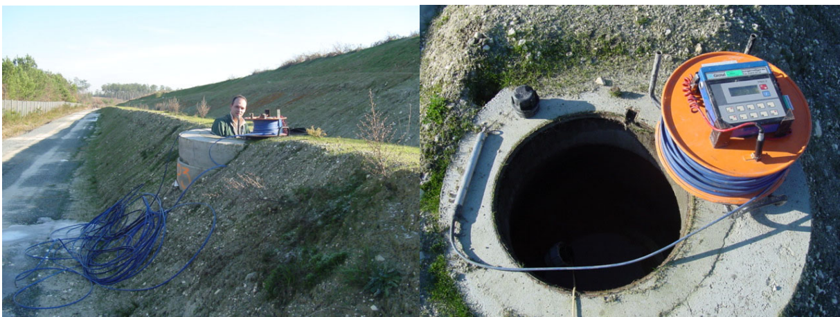
Figure 14. Illustration d'une mesure profilométrique (CSD de Lapouyade) (a) Technicien opérateur en action à partir d'un cuvelage en béton fondu dans la digue périphérique (b) Gros plan sur la sonde accélérométrique à l'entrée du cuvelage.
