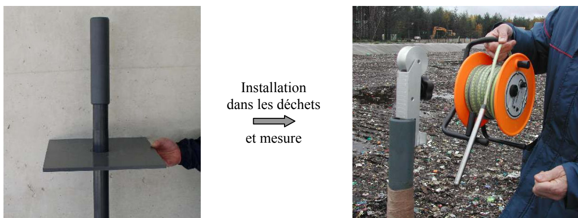
Figure 24. Extensomètre magnétique (a) Gros plan sur la plaque aimantée et le tube télescopique avant installation (b) Mesure au moyen de la sonde électromagnétique (CSD de Mende).
