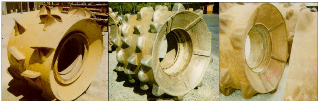
Figure 4. Illustration des roues de compacteur couramment observées (a) couteaux (b) dents polygonales à double alignement (c) dents en forme de croix.
