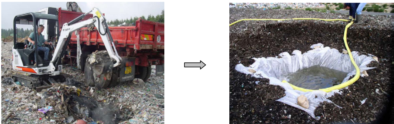
Figure 26. Mesure de densité des déchets de surface (a) Excavation à la pelle (CSD de Saint-Paul de Tartas) (b) Remplissage du puit excavé et étanché à l'aide d'une citerne d'eau (CSD de Mende)
