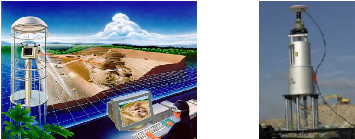
Figure 16. Illustration du suivi des tassements par scanner laser 3D (a) appareil monté sur tourelle fixe (b) appareil monté sur véhicule mobile (Source : < www.riegl.co.at >)
